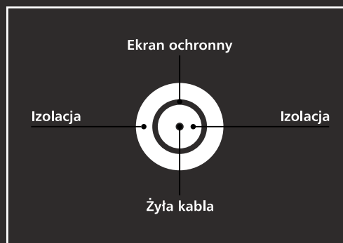
Przekrój poprzeczny kabla wraz z opisem Skala 1 : 3
